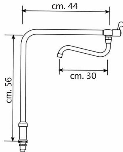
Cod. 3808 - Colonnina orientabile in ottone cromato, rotazione 90°, bocca erogazione orientabile diam. 20 portata 3 bar 32 l/min. - foratura mm 27
